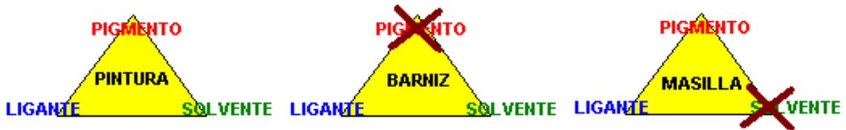
El nombre que recibe una pintura depende del tipo de ligante o vehículo no volátil del cual está formada, es así como se nombran **alquídicas, epóxicas, vinílicas, asfálticas, caucho clorado**, ( que son resinas sintéticas y artificiales ) etc.... a su vez la clasificación anticorrosivo o esmalte depende del tipo de pigmento. Es común entonces hablar de: **anticorrosivo epóxico, esmalte vinílico, anticorrosivo alquídico, esmalte alquídico**, etc.
